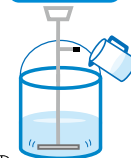
練混ぜ水の計量
