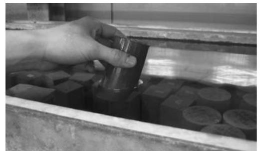
※写真では鋼製型枠を用いてますが、プラスチック、ブリキ等の型枠の場合も同様の作り方で行ないます。
