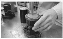
上面を研磨する場合は1~2mmの盛り上げをして、 ペーストキャッピングする場合は上端から1~2mm 下げます。
