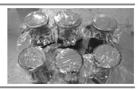
無収縮モルタルの硬化を待って、丁寧に型枠を取り 外します。脱枠は、通常詰め終わってから 翌日~2日後程度とします。
