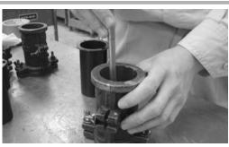
型枠を軽くタッピングして、空隙をなくします。
